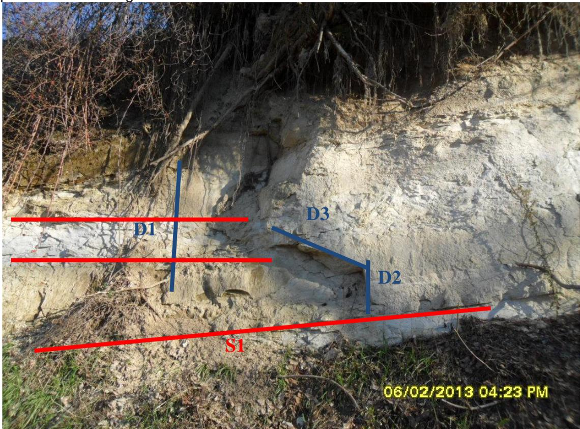
Dall'immagine si può vedere un esempio di distacco di un blocco: i tre sistemi di discontinuità (rappresentati in blu), intersecando la stratificazione (rappresentata in rosso) piano parallela, hanno determinato l'isolamento di una porzione di roccia causandone il distacco.
