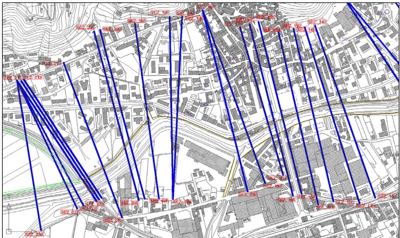
*Figura 2 – Sezioni del Modello Idraulico Numerico – Concentrico monte*
